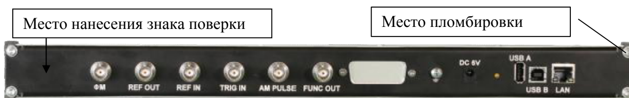
Рисунок 6 - Внешний вид задней панели генераторов сигналов RFSG12, RFSG20, RFSG26 с опциями RFSG12-1URM, RFSG20-1URM, RFSG26-1URM соответственно.
